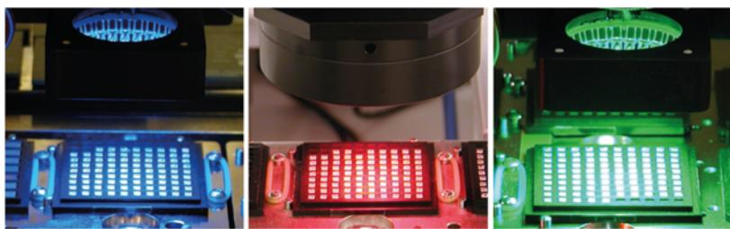
不论材料对比和检测如何，高级视觉必须快速执行稳健的衬底基准点对准，并且  $360^{\circ}$  确定芯片的方位。模式识别和边界轨迹工具能够为管芯中心或边缘定位，或者关键应用特性识别方面提供完整的解决方案。从而快速无误地处理复杂装配体。
